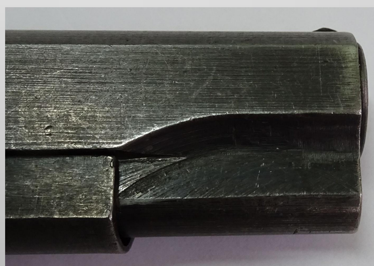
Pistolet Vis produkcji wojennej. Na zdjęciu fragmentu broni są widoczne ślady niestarannej obróbki.
