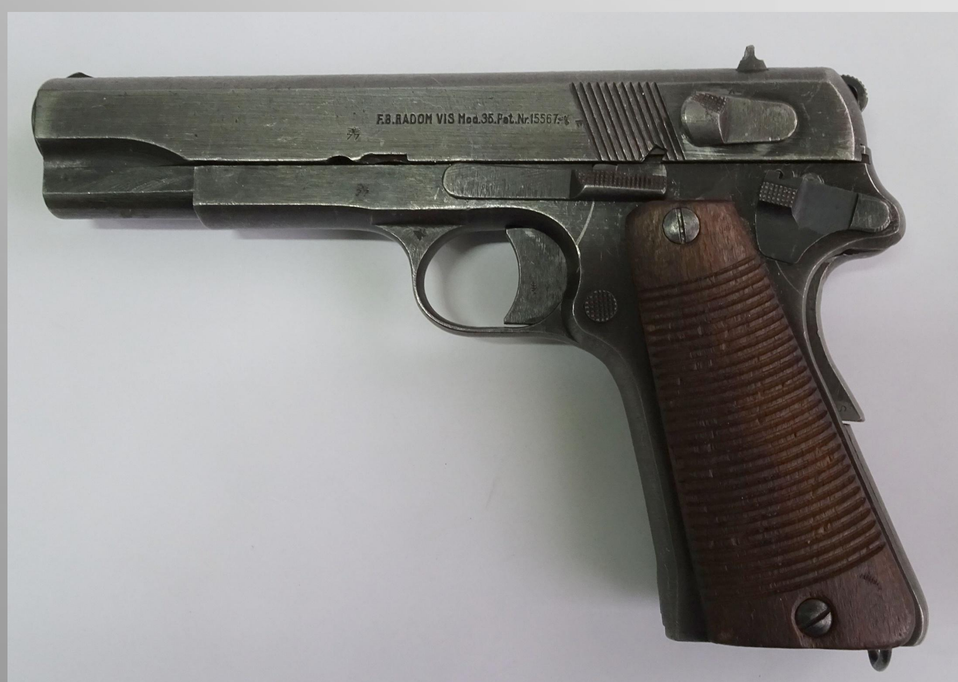
Pistolet Vis produkcji wojennej. Na zdjęciu fragmentu broni są widoczne ślady niestarannej obróbki.
