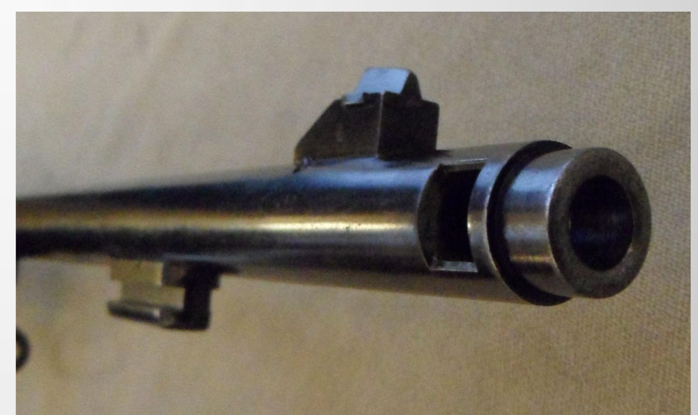
Muszka, obsada bagnetu i hamulec wylotowy.
