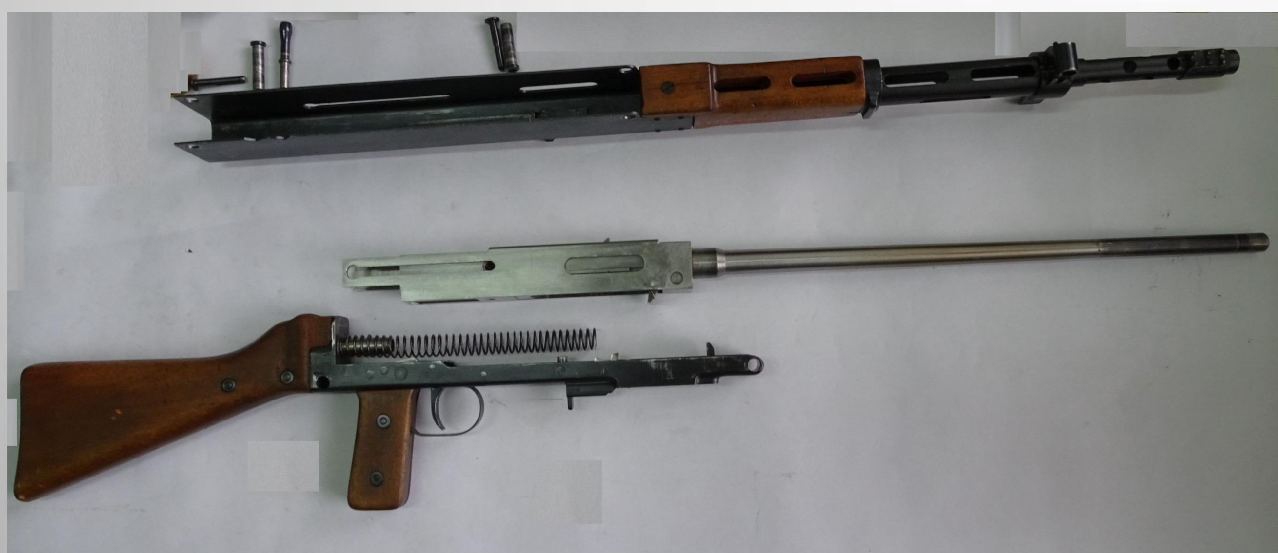
Karabinek SJ-57 częściowo rozłożony - lufa w komplecie z komorą zamkową, suwadłem i zamkiem Zdjęcie J. Kostro
