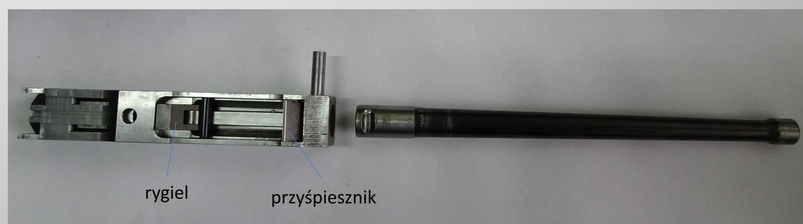
Lufa odłączona od komory zamkowej z suwadłem i zamkiem
