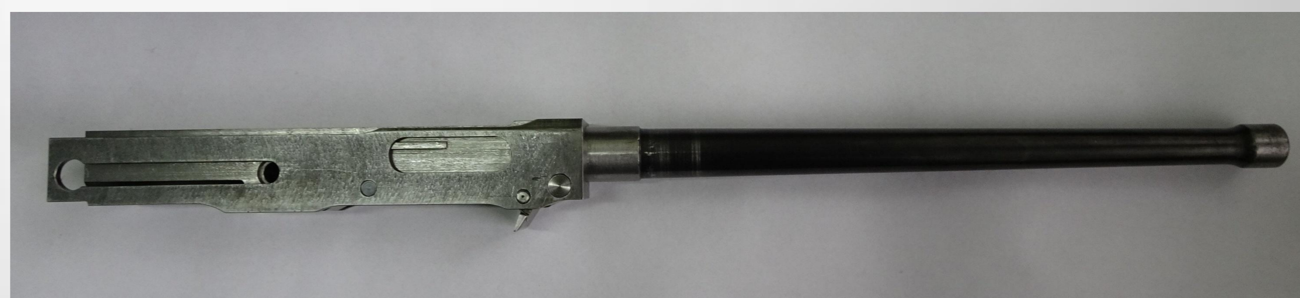
Lufa w komplecie z komorą zamkową, suwadłem i zamkiem
