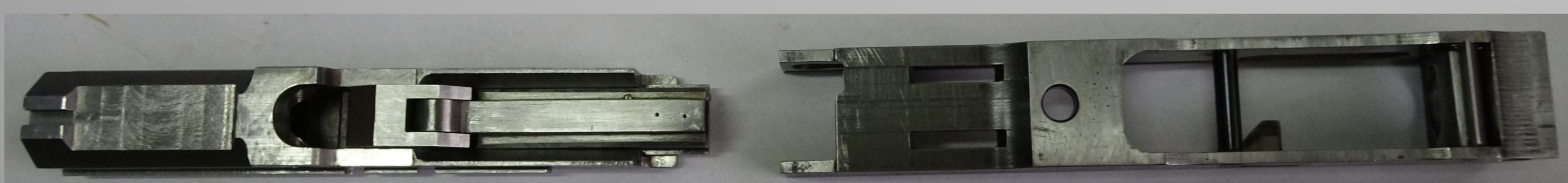
Zespół suwadło-zamek odłączony od komory zamkowej (bez lufy)
