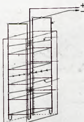
Rys. 3d. Elektrody prętowo - armaturowe.
