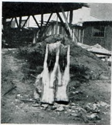
Rys. 3. Rozlupany pal z wygnitym gniazdem od pozostałej na wierzchu wklęsłości.
