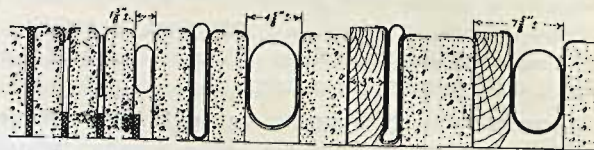
Rys. 1. Poszczególne fazy przesuwania nawierzchni drogowej.
