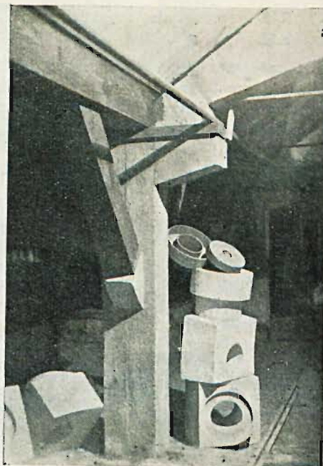
Bloki szamotowe i armatura pieca.
