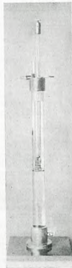
Rys. 3. Przyrząd do pomiaru oporności wody.
