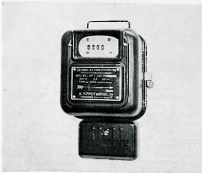
Pierwszy licznik, wykonany w kraju. Typ BT 3 RPT 3,85 200 woltów 5 amp.
