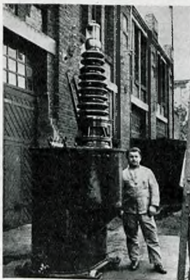
Rys. 1. Transformator probierczy 150 000/380 V dla Fabryki Por- celany „Cmielów”.
