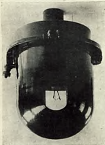
Rys. 8. Lampa sufitowa w budce maszynisty.
