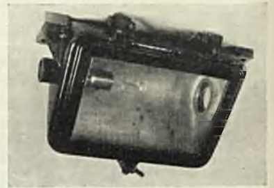
Rys. 9. Lampa do oświetlenia mechanizmu korbowodu.
