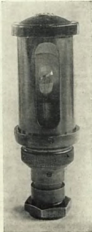
Rys. 7. Lampa do oświetlenia szybkościomierza w budce maszynisty.
