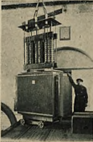
Rys. 5. Transformator 800 kVA Brown Boveri
