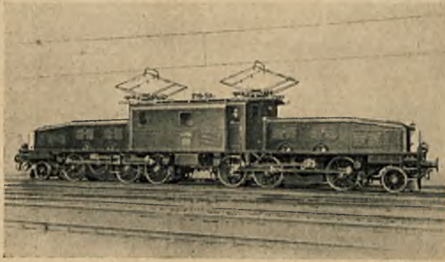
Rys. 4. Lokomotywa z napędem zapomocą długich pochylonych drągów bez wału ślepego.
