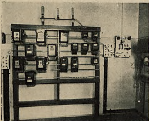
Rys. 13. Urządzenie do długotrwałych badań liczników prądu zmiennego.
