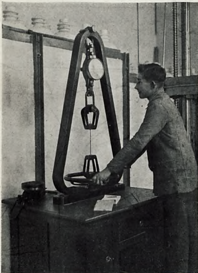
Rys. 15. Przyrząd dynamometryczny do badania wytrzymałości przewodników podług § 3 „Przepisów technicznych na linje elektryczne napowietrzne”. Konstrukcje i wyrób Gródka.
