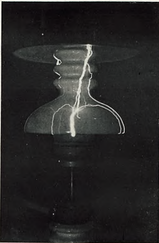
Rys. 14. Wyładowanie kilku fal uskokowych o napięciu 500 000 V na izolatorze typu „Hoffmanna” (Górny talerz żelazny).
