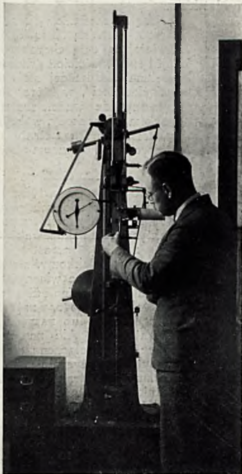
Rys. 18. Rozrywanie przewodników maszyną Amslera o maks. sile 500 kg.
