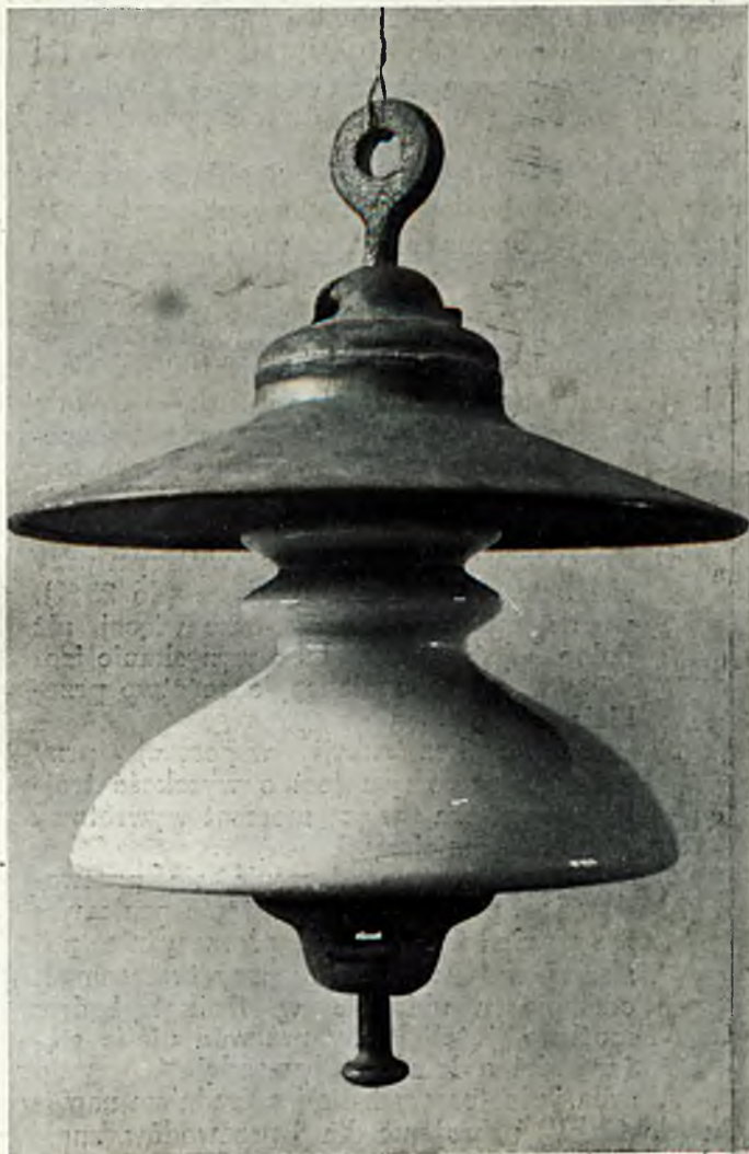
Rys. 8. Masywny izolator wisiorowy typu „Hoffmann” dla napięcia roboczego 35 kV. Przeskok na sucho — 130 kV, na mokro — 95 kV.
