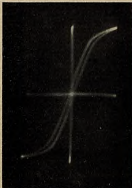
Rys. 18. Krzywa histerezy dla próbki z blachy żelaznej — f = 50 okr./sek.
