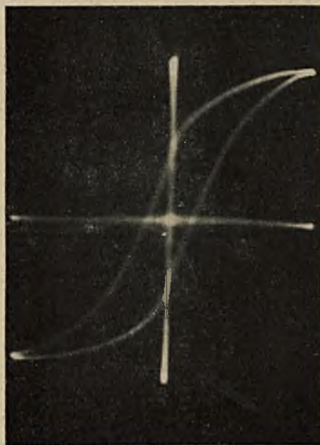
Rys. 17. Krzywa histerezy dla próbki z żelaza łanego — f = 50 okr./sek.
