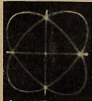
Rys. 11. Krzywe Lissajou dla 2 napięć przesuniętych w fazie o 60° i 120°.
