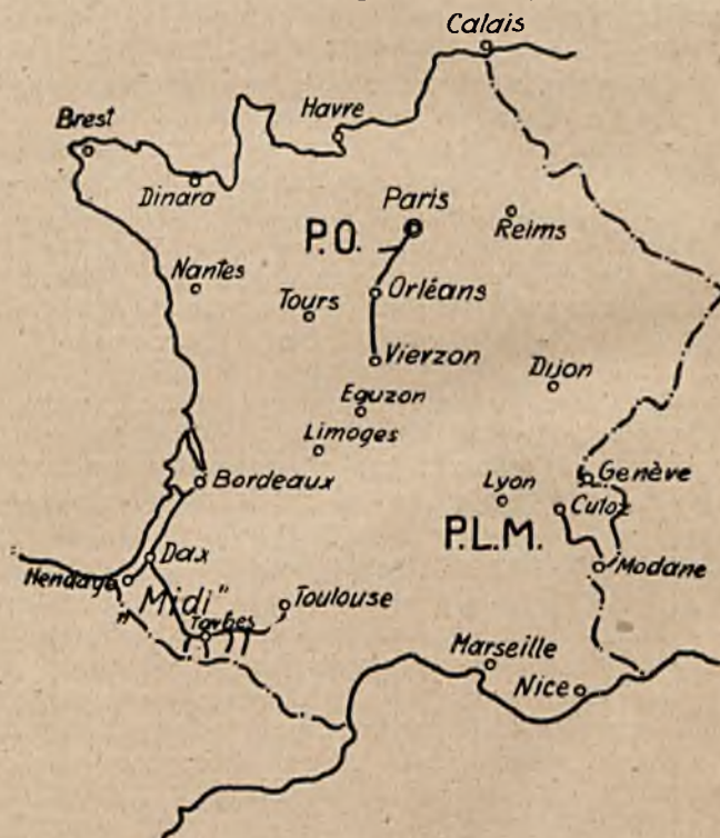
Fig. 1. Plan zelektryfikowanych dotąd francuskich linii kolejowych.
