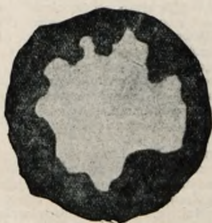
Rys. 10. Obraz dyfuzji soli fluorowej
