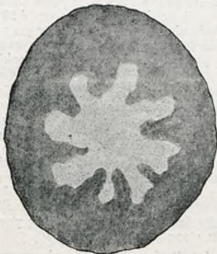
Rys. 12. Obraz dyfuzji środków impregacyjnych w 2 lata po ich zastrzyknięciu.
