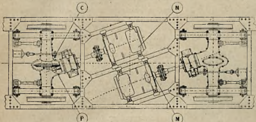
Rys. 17. — Podwozie wag. paryskich typu L z pomostami na końcach wagonu. Napęd syst. Albrecht Krupp, (rys. 18) jest bardzo solidne, w niektórych szczegółach o wiele cięższe, niż napędu paryskiego.
