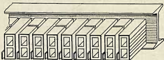
Przy rozstawieniu belek do 2 m z bednarką 1 x 20 mm.
