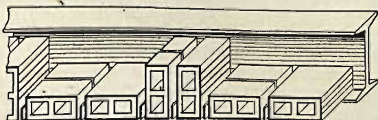
Przy rozstawieniu belek do 2 m z bednarką 1 x 20 mm.
