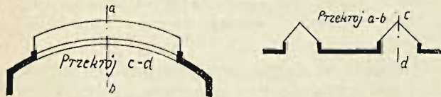
Rys. 11. Hala pokryta świetlikami trójkątnymi gęsiennicowymi.
