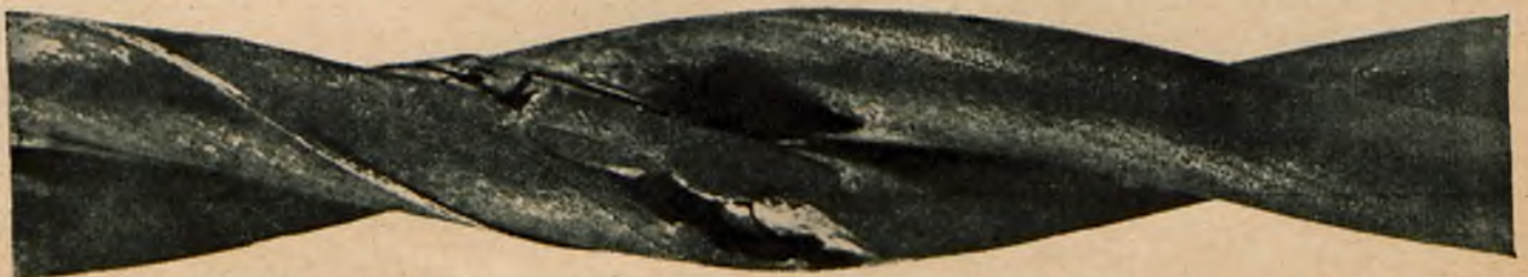
Rys. 4. Skaza ujawniona przez skręcanie żel. okr. w pręt stali Isteg.
