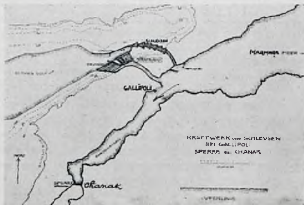
Rys. 3. Zamknięcie Dardaneli (około Chanak). Widoczny kanał łącznikowy, śluzy, siłownia oraz port koło Gallipoli.
