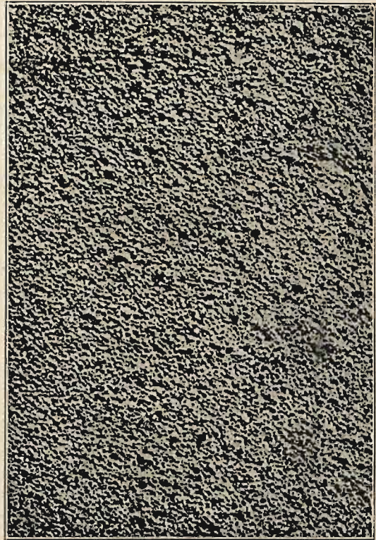
Rys. 1. Przekrój przez celolit, przedstawiający jego strukturę, z niezliczoną ilością drobnych komórek powietrznych.
