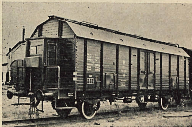
Rys. 8. Wagon serii Sd do przewozu drobiu, zbudowany w wytwórni S. A. Wielkich Pieców i Zakładów Ostrowieckich.
