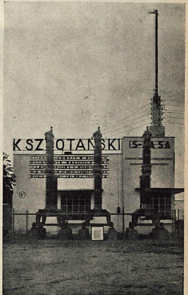
Rys. 5. Wyłącznik małoolejowy firmy Szpotański.
