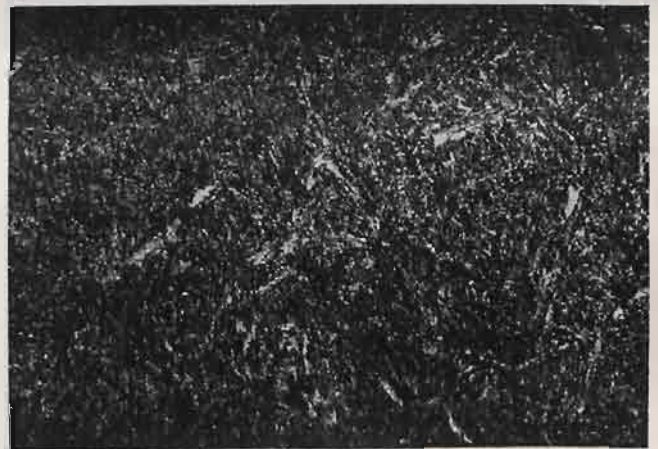
Rys. 6. Ulepszenie zastępcze doskonałe, struktura nierównomierna — sorbityczna.
