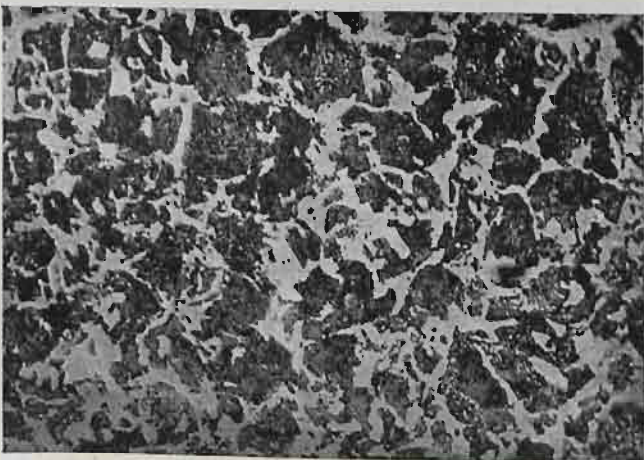
Rys. 3. Struktura perlityczna o najkorzystniejszych właściwościach wytrzymałościowych (szybkość chłodzenia 4,5°/sek)
