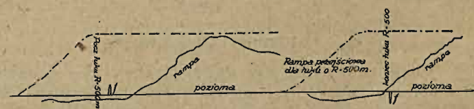
Fig. 11. Dwa przepisowo ułożone wzniesienia przechyłkowe, jednakowoż nie zaczynają się one we właściwym punkcie początku łuku. Początek wzniesienia przypada prawie na początek łuku, podczas gdy powinien być przesunięty o 20 m (10 m przed rozpoczęciem krzywej przejściowej). Linje przerywane wskazują należyte położenie wzniesień.
