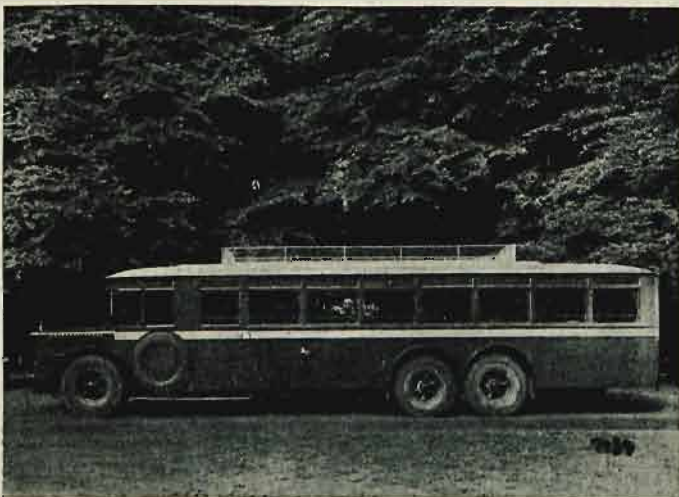
Rys. 1. Autobus Büssing Podwozie o nośności 9,5 t., pasażerów 60
