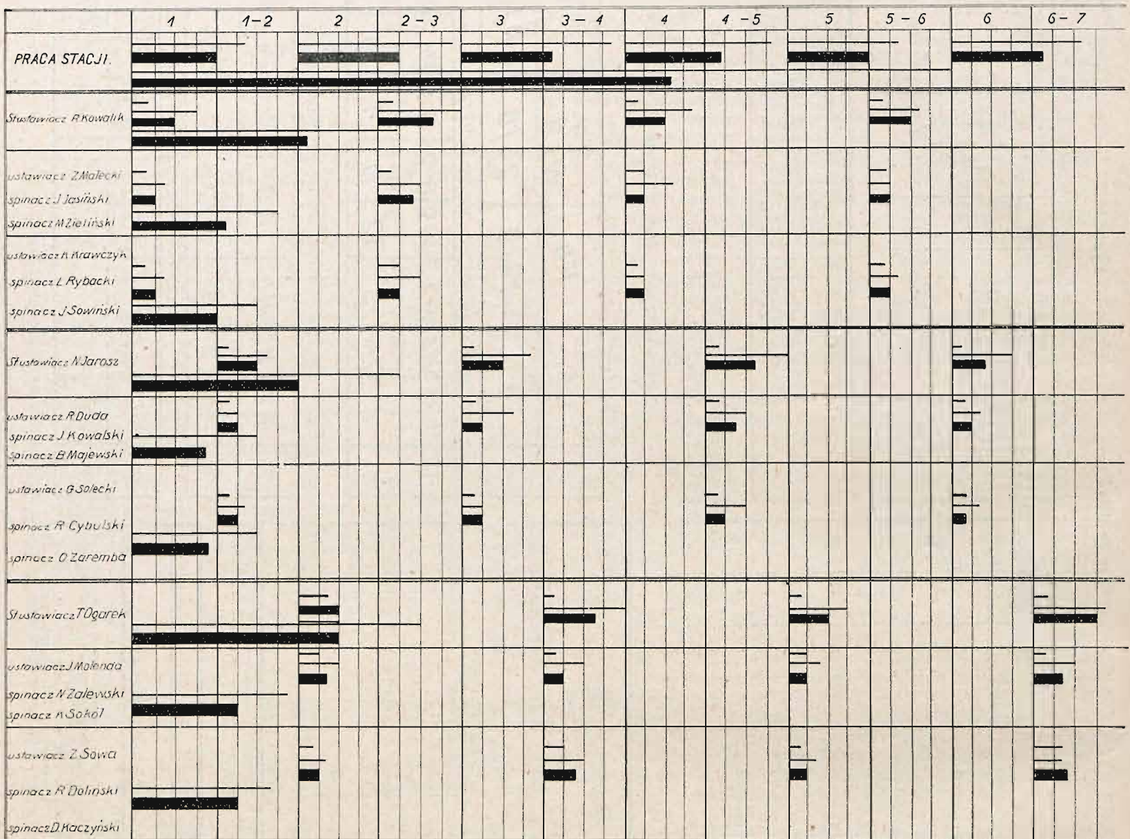
Wykres formowania pociągów na st. Lublin za miesiąc Kwiecień na wzór wykresów Gantt'a.
