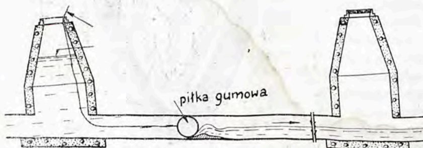
Rys. 236. Oczyszczanie kanału piłką gumową.
