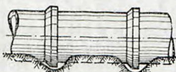
Rys. 265. Ułożenie rur na dno wykopu.
