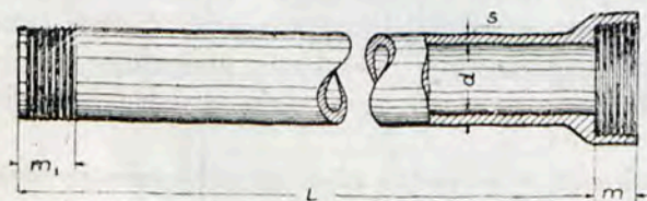
Rys. 27. Rura kamionkowa prosta wg Polskich Norm.
