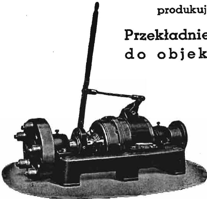
Przekładnia zwrotna do statku rzeczno N-160 KM., n-300/300 obrz/min
