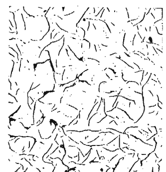
Rys. 30. Duże płatki grafitu, pokazane na rys. 28.
