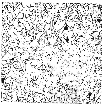
Rys. 28. Różne wymiary płatków typu dendrytycznego. 60% o wymiarze 4 typu A 40% „ 7 „ C
