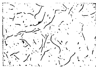
Rys. 2. Grafit w postaci płatków (A-Ia1-β). Nie traw. \times 100
