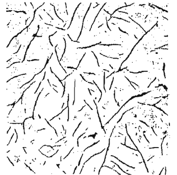
Rys. 23. Typ A. Różnokierunkowa orientacja płatków rozmieszczonych równomiernie. \times 100
