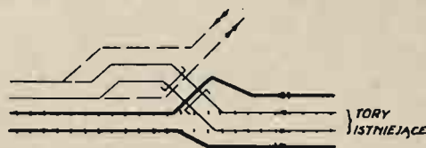
Rys. 7. Przejście do układu kierunkowego do liniowego na szlaku.
