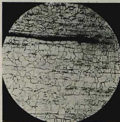
Rys. 14. Zdjęcie mikroskopowe tworzywa ścianki. Trawiono 4% roztworem kwasu azotowego w alkoholu etylowym. Pow. 80 kr.
