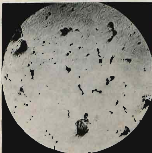
Rys. 10. Zdjęcie mikroskopowe nietrawione. Powiększenie 80-krotne.
