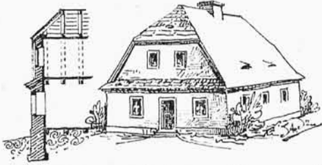
Rys. 20. Dom murowany z dachem naczółkowym polskim. Zewnętrzna odsadzka ściany szczytowej pokryta okapem-daszkiem przyżbowym.
