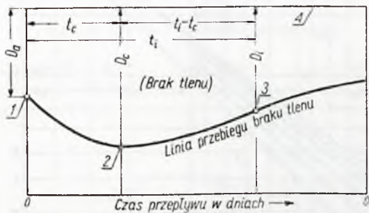
Rys. 233. Trzy punkty linii nasycenia tlenem 1 — punkt wyjściowy, 2 — punkt najniższy, 3 — punkt zwrotny, 4 — pełne nasycenie
