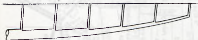
Rys. 69. Licowanie dna kanałów dochodzących bocznych z dnem kanału głównego
