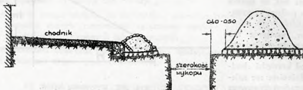
Rys. 268. Wykop dla ułożenia rur wodociągowych.
