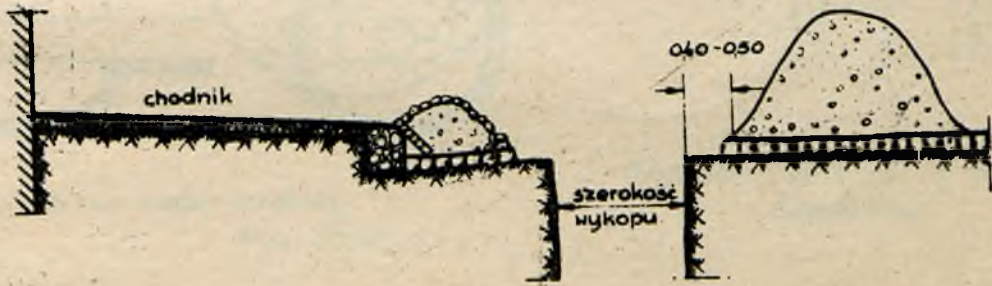
Wykop dla włożenia rur wodociągowych Rys. 225.
