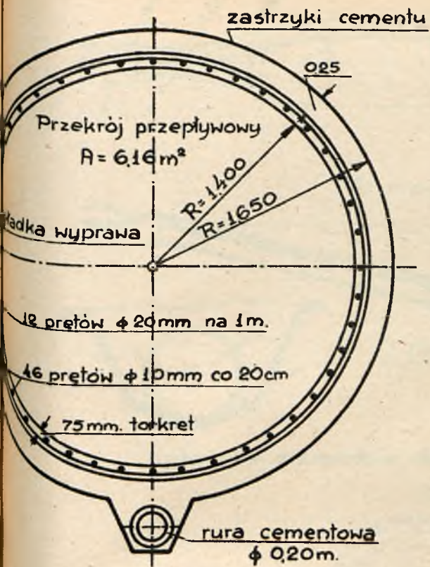
betonowa obudowa sztolni. Rys. 154.
