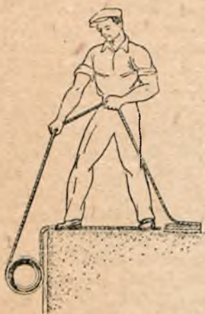
Rys. 240. Opuszczanie rur mniejszej średnicy do wykopu
