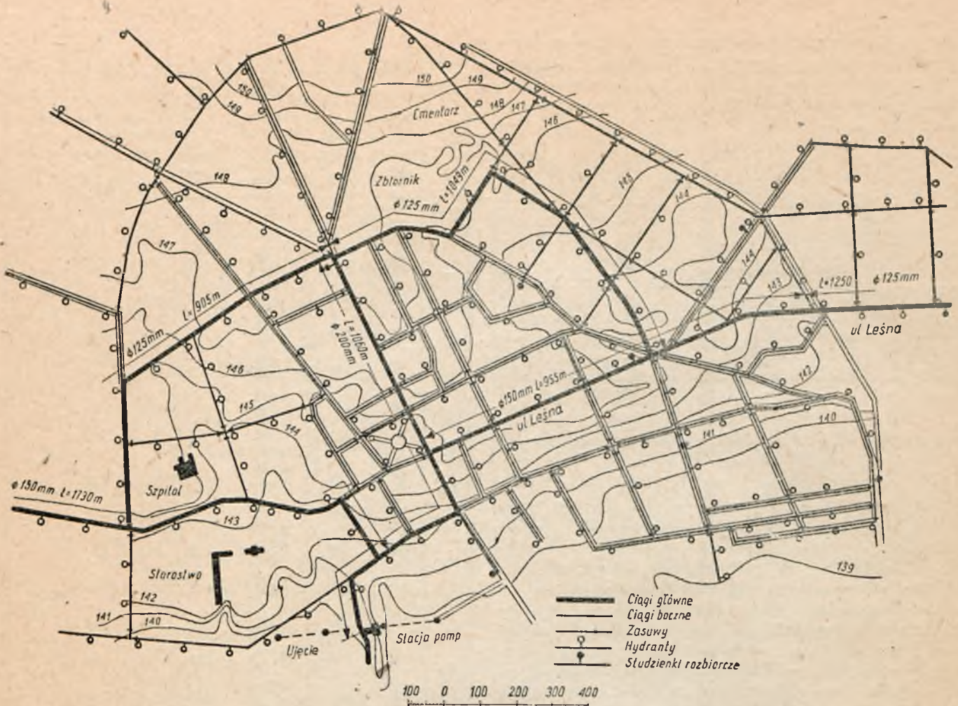
Rys. 215. Projekt sieci rozdzielczej
