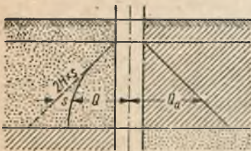
Rys. 56. Zależność między wydatkiem studni a depresją
