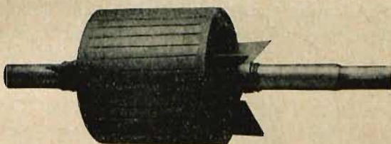
Rys. 16. Wirnik zwarty silnika asynchronicznego trójfazowego, z wachlarzykami dla przewietrzania.
