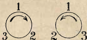
Rys. 21. Tu wymieniono położenia faz 2 i 3, skutkiem czego kierunek ich kolejności na obwodzie zmienił się na odwrotny.
