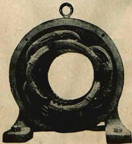
Rys. 15. Uzwojony stojan silnika asynchronicznego trójfazowego.
