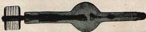
Rys. 64a. Rurka rentgenowska firmy Gaiffe-Gallot et Pilon w Paryżu do prześwietlania ciała ludzkiego. Daje promienie bardzo silne. Może być włączona na prąd zmienny bez prostowników. Blaszki z lewej strony służą dla chłodzenia anody.
