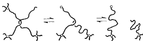
Rys. 9. Mechanizm molekularny rozpadu (powstawania) węzłów w sieci splątań na skutek wyslizgiwania się (wślizgiwania się) swobodnych końców łańcuchów
