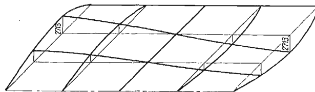
Rys. 7. Wykres momentów M_{xy} w kGcm/cm dla q = 0,26 kG/cm 2 , \Delta T = 75^\circ\text{C} , t = 28 dni
