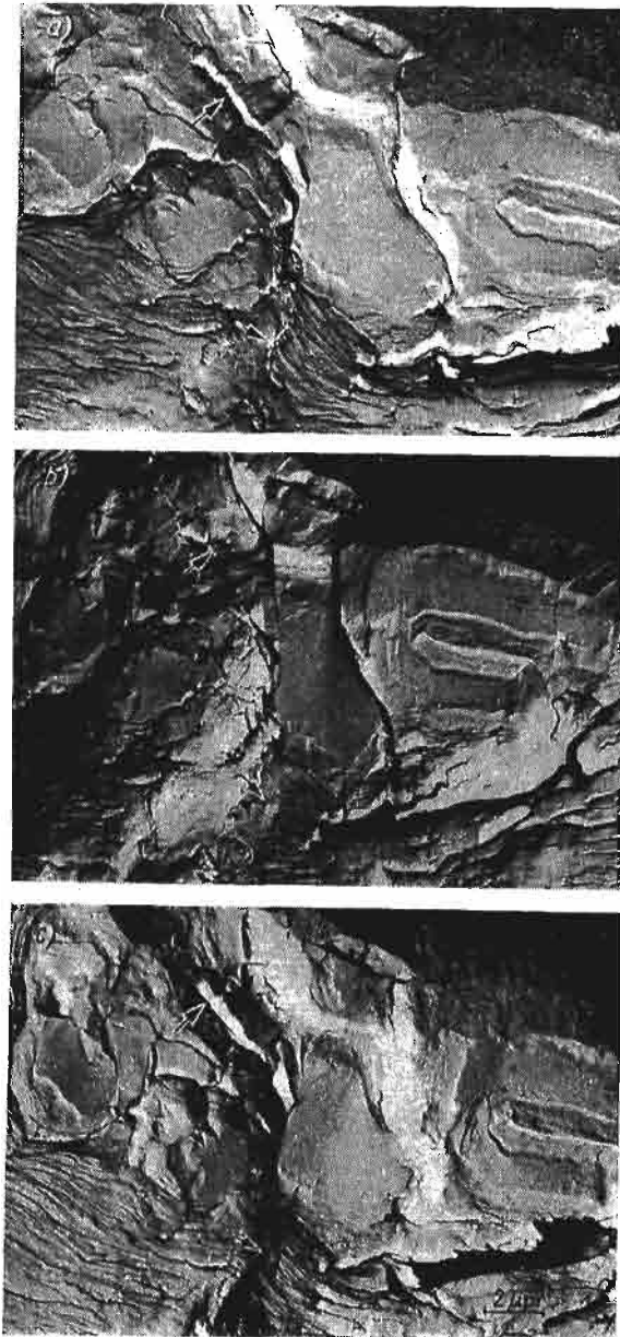
Rys. 5. Wycinek powierzchni złomu zmęczeniowego stopu PA6 z pęknięciami łupliwymi w wydzieleniach faz wtórnych, oglądany przy nachyleniu repliki 0^\circ (a), -30^\circ (b) i +30^\circ (c). Strzałki na rys. 5c wskazują na większy uskoki
