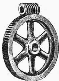
Rys. 89. Przekładnia ślimakowa w mechanizmie podziałowym obrabiarek do kół zębatych.
