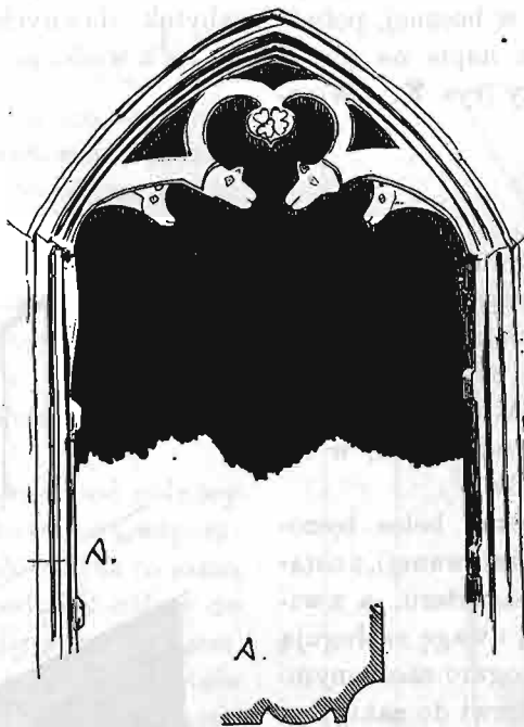
Rys. 16. Odrzwia dębowe do dzisiejszej zakrystyi.
