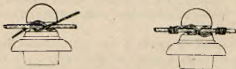
Rys. 129. Inny sposób przywiązywania przewodu.
