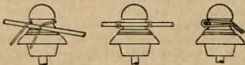
Rys. 128. Przywiązanie przewodu przy szyjce izolatora.
