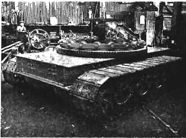
Rys. 2. Podwozie koparki gaśnicowej i pierścień obrotowy.
