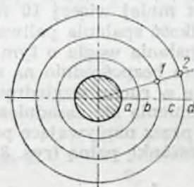
Rys. 8.2. Schemat parowania kropli paliwa ciekłego w nieruchomym otoczeniu
