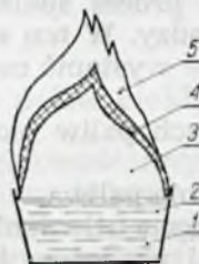
Rys. 8.1. Spalanie paliwa ciekłego na wolnej powierzchni: 1 — zimne paliwo, 2 — warstwa paliwa ograniczonego, 3 — strefa par i produktów rozpadu termicznego, 4 — strefa spalania, 5 — obszar dopalania
