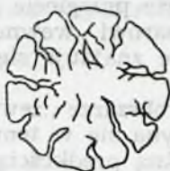
Rys. 9.7. Schemat spalania węgla w porach
